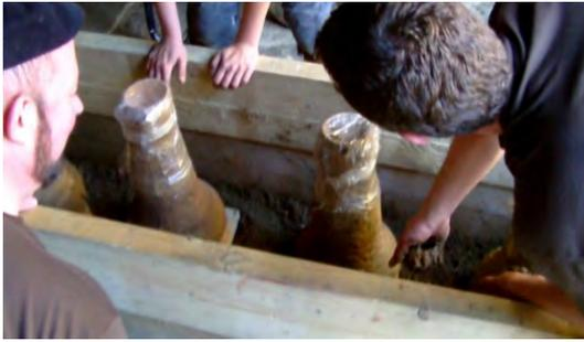
Les fondeurs recouvrent la partie inférieure du moule avec de la terre mouillée afin de bloquer la chape.
